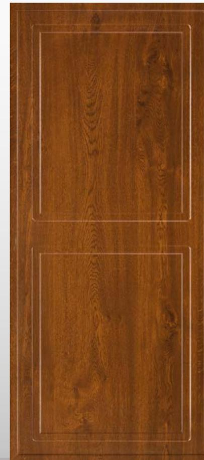
Scuretti interni, realizzati in HDF exterior. Con battuta perimetrale a 15 mm. Per altezze inferiori a 1 mt: 1 riquadro. Per altezze superiori a 1 mt: 2 riquadri.
